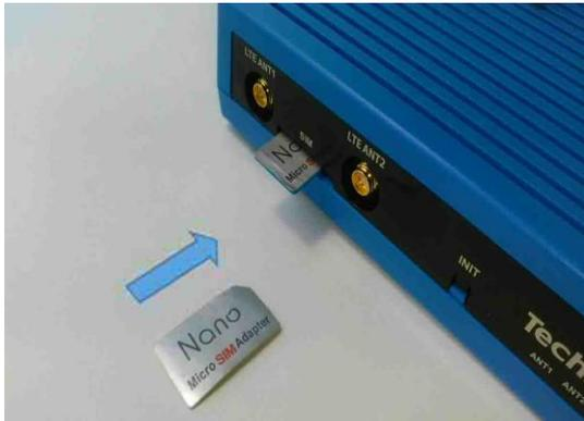
① MRB-50LにSIMカードを図の向きでカチッと音がするまで挿入します。
