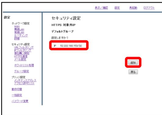
⑤入力したIPアドレスを確認し、正しければ『追加』をクリックして設定は完了です。
